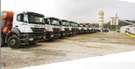
**U**ne centrale équipée de 8 toupis de 12 m<sup>3</sup> et 3 pompes à béton respectivement de 38 m<sup>3</sup> – 47 m<sup>3</sup> – 56 m<sup>3</sup>
